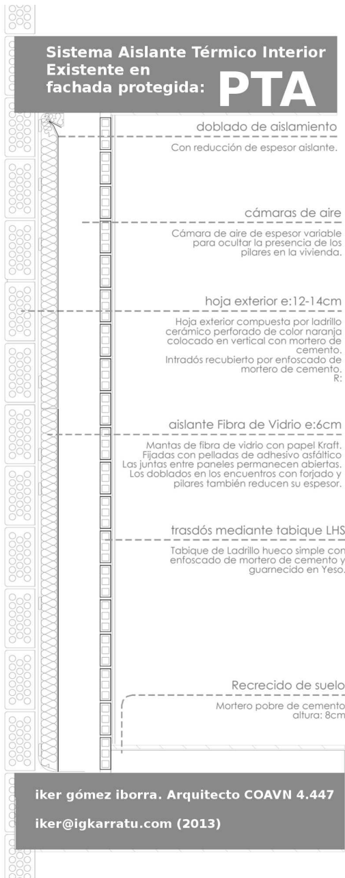
Fig. 3: Secciones constructivas de la envolvente según estado previo y reformado.
